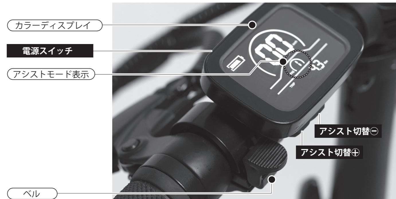
電源スイッチ:走行時にこのスイッチを押して電源をONにしてください。
